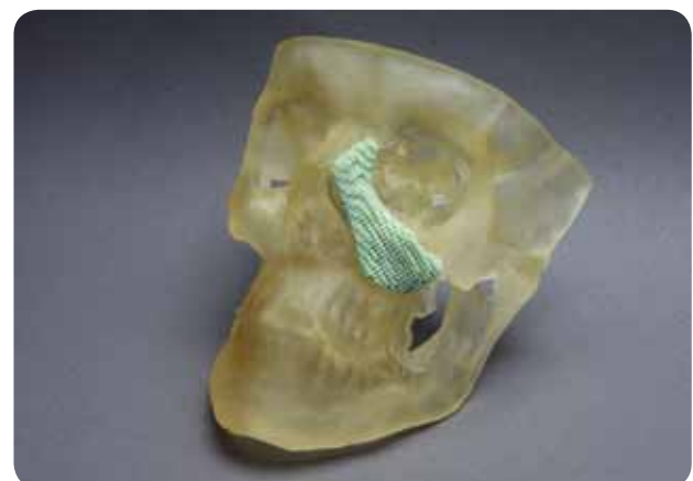
Abbildung 4: 3D-gedrucktes patientenindividuelles Implantat
