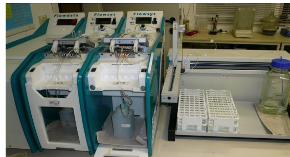
Unser Nährstoffanalyser für Phosphat, Nitrat und Ammonium.
